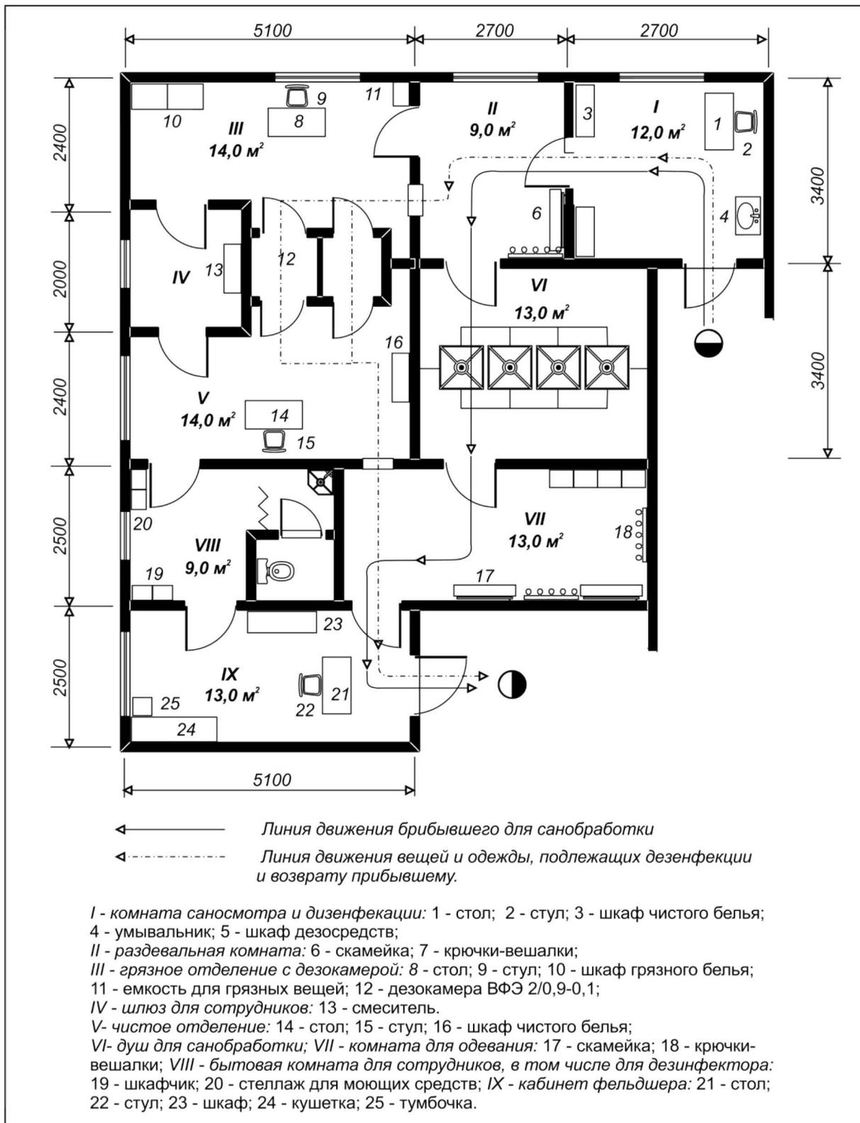
Рисунок В.4 Санпропускник (примерное решение на 200 мест)
