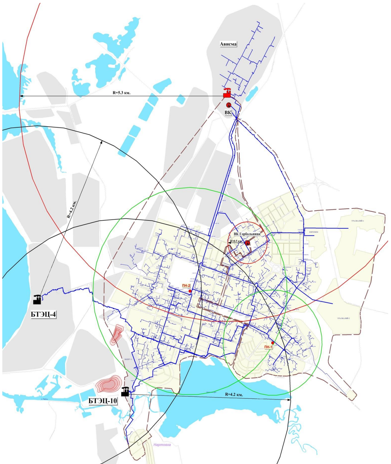
Рисунок 1 - Схема тепловых зон и радиусов эффективного теплоснабжения ТЭЦ-2, 4,10, ВК Гор. Больница
