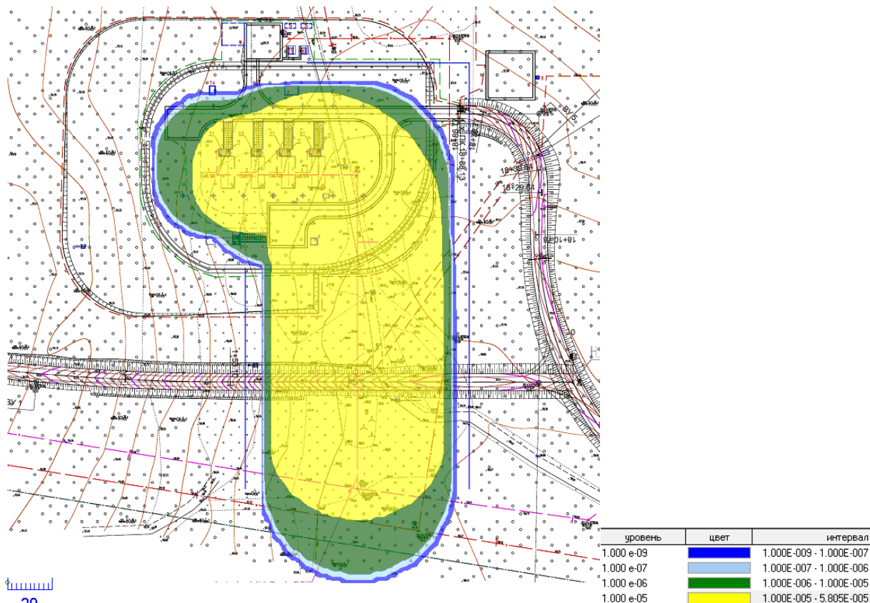
Рисунок 8 – Распределение потенциального (территориального) риска гибели при аварии на проектируемом оборудовании (оборудование на площадке куста №104)
