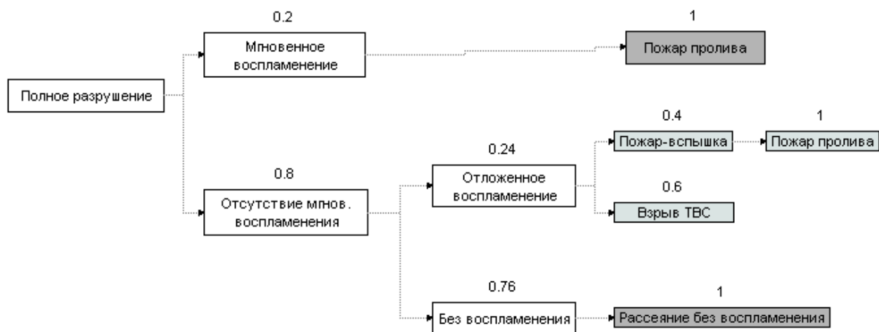
Рисунок 1 - Дерево событий при полной разгерметизации для трубопроводов
